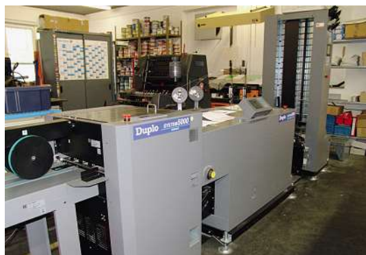
Die FKS/Duplo-Balkenrillmaschine DuCreaser DC-445 und das System 5000 mit Zusammentragturm sorgen bei Munding Druck in der Weiterverarbeitung für ein perfektes Finishing. R&S in Leonberg zeichnet hierfür verantwortlich.
